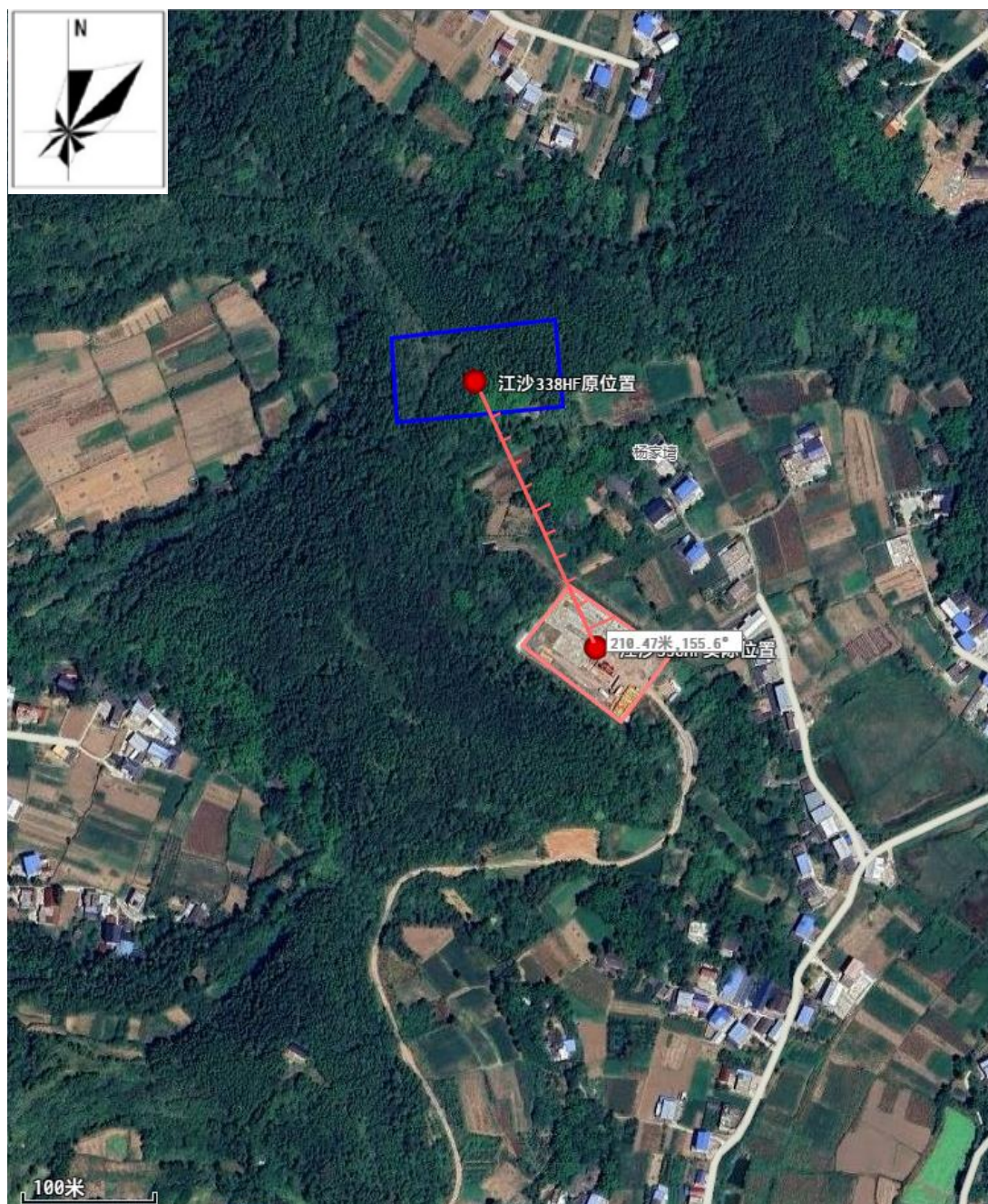
图 2.1-1 江沙 338HF 井位置偏移示意图
